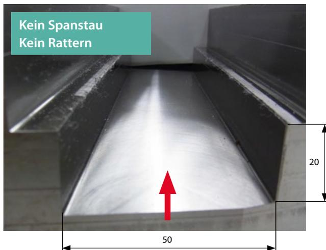
Schnittbedingungen:  $V_c = 40$  m/min,  $a_p \times a_e = 20 \times 50$  mm (Nutenfräsen,  $f_z = 0,08$  mm/Z  $\phi 50$  (5 Span-Nuten), Nassbearbeitung (Außen- und Innenkühlung), Werkstück: Ti6Al4V Maschine: BT50
