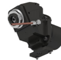
Winkelfräskopf ER 32, IK, i = 1:1 angepasster Winkel für Schrägbohrungen
