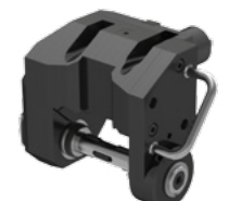
Scheibenfräskopf Scheibenfräser, EK, i = 3:1 Fräsen von Nuten und Nockenformen (mit 2 Frä- sersn gleichzeitig).
