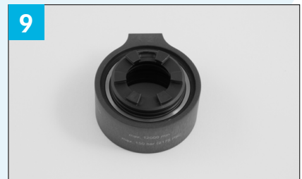
9 Sicherungsring montieren. ACHTUNG: Muss einrasten.
