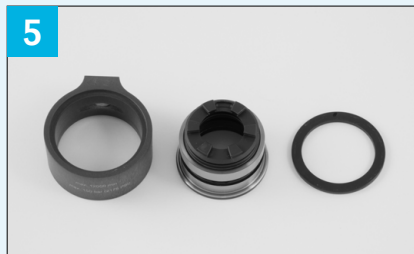
5 Alle Teile mit Industriereiniger reinigen.
