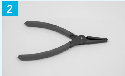
2 Mit Zange Sicherungsring demontieren.
