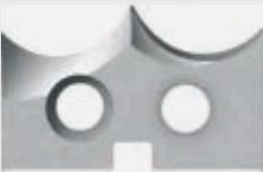
Anschliff für faserverstärkte Kunststoffe (HM)
