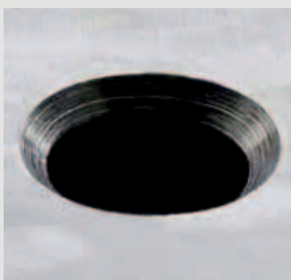
Senkung mit Standardsenker
