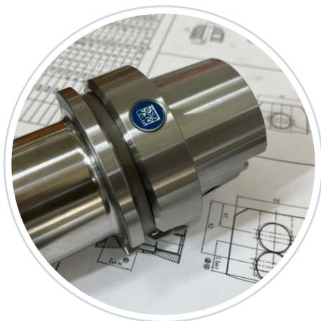
**Der Chip kann mit einem QR-Reader gelesen werden.** So kann die Werkzeugaufnahme in einer Werkzeugverwaltungssoftware eindeutig identifiziert werden.
