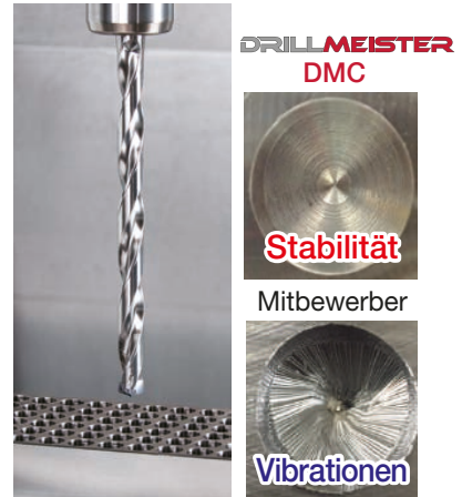
Schnittdaten: V_c = 100 \text{ m/min} , f = 0.3 \text{ mm/U} Bohrer-Ø: \varnothing 13 , L/D = 12 (Ohne Pilotbohrung) Werkstoff: C55
