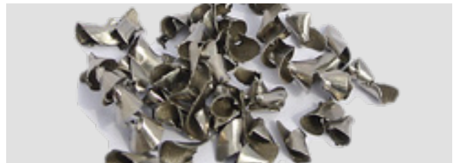
Schnittbedingungen: Werkstück: rostfreier Stahl 316L, VC = 60 mm, f = 0,16 mm/U.
