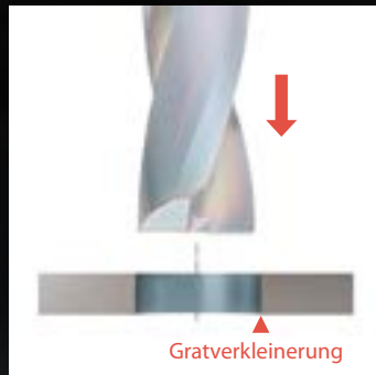
Tauchfräsen auf dünner Platte
