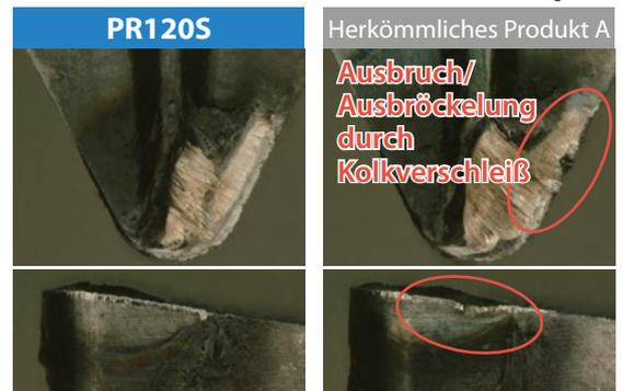
Schnittbedingungen: Vc = 150 m/min, ap = 1,0 mm, f = 0,08 mm/U, Nassbearbeitung SUS316L Typ DCGT11T304
