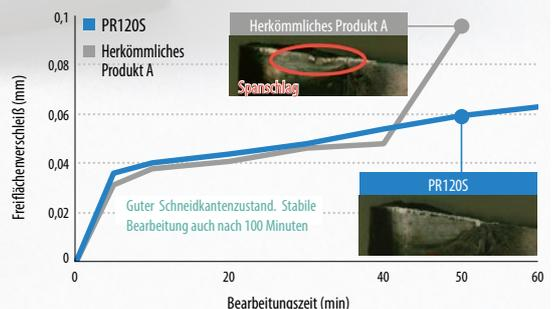
Schnittbedingungen:  $V_c = 150 \text{ m/min}$ ,  $a_p = 1,0 \text{ mm}$ ,  $f = 0,08 \text{ mm/U}$ ,
