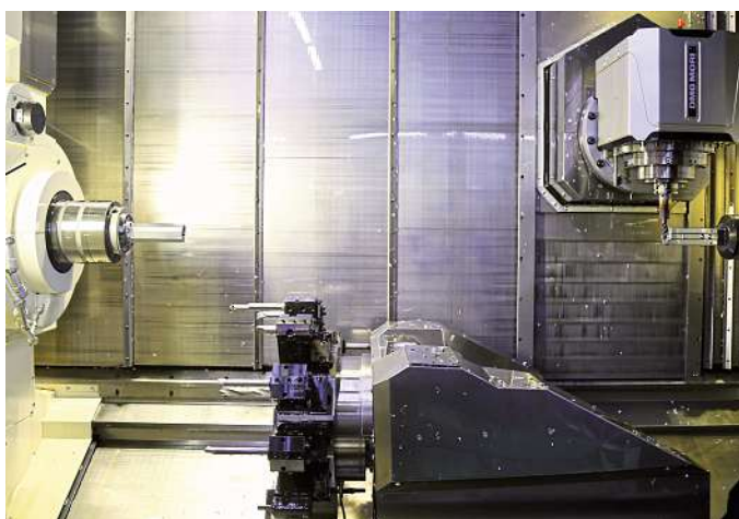
Blick in das Multitask-Zentrum mit Haupt- und Gegenspindel. Aeschlimann perfektioniert die Prozesse, indem die optimalen Werkzeuge für die jeweiligen Bearbeitungen evaluiert werden.
